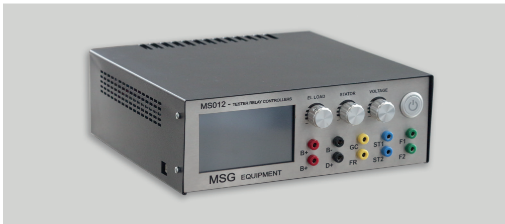
Рис. 1. Тестер MS012 COM - Вид спереди
