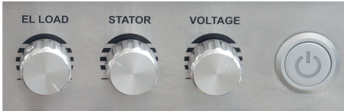
Рис. 8. Тестер MS012 COM - Регуляторы и кнопка включения
