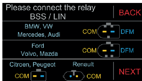
Рис. 10. Графическое обозначение расположения терминала «COM» в самых распространенных разъемах реле-регуляторов
